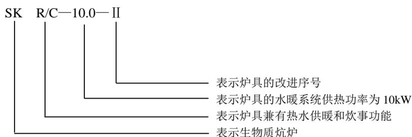
表示该炉具是燃用生物质燃料的炕炉，兼有热水供暖和炊事功能，供热功率为10.0kW，改进序号为II型的炕炉。
